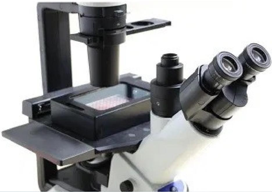
配合倒立顯微鏡對活細胞培養過程，進行長時期延時觀察及記錄。整套系統包含環境控制器和細胞培養艙，環境控制器可由觸控式面板，精確控制細胞艙內的濕度、溫度、二氧化碳、氧氣或氮氣濃度，達到有效長時間細胞培養。
